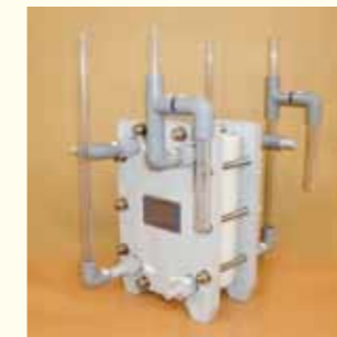
T-O 透析槽 T-O diffusion dialyzer
